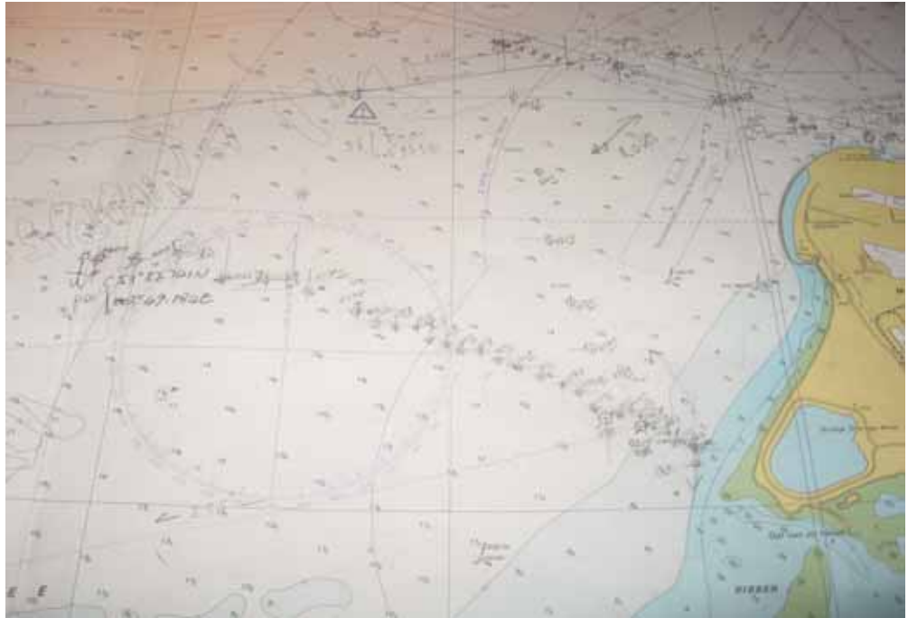
Figuur 2: De aan boord gebruikte zeekaart, met daarin door de bemanning bijgehouden positie, en uiteindelijke plaats van gronding.
