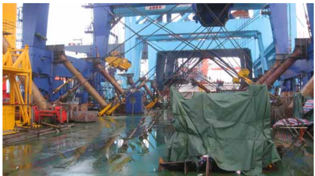
Figuur 1: sjorringen van de containerkranen aan dek
